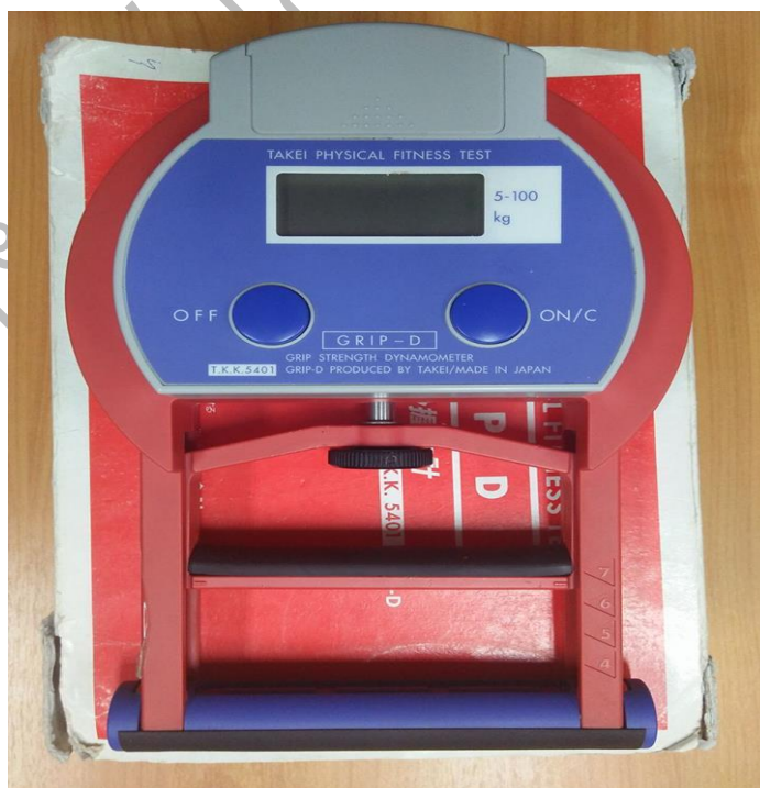
วัดความแข็งแรงของกล้ามเนื้อมือด้วยเครื่องมือ Hand-grip Dynamomete
